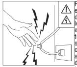
Rischio di scossa elettrica con pericolo di morte. Non toccate le parti in tensione elettrica e mantenete una distanza di sicurezza. Prima di ogni manutenzione scollegate la spina dalla presa di alimentazione.
