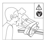
Lancio di materiale e polvere verso gli occhi ed il corpo dell'operatore. Indossate occhiali di protezione e maschera antipolvere.
