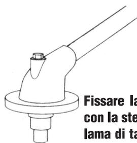
**Fissare la testa in alluminio con la stessa modalità di una lama di taglio, poi avvitare il corpo con i fili**
