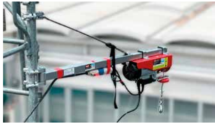
1450554 SUPPORTO A BANDIERA PER PARANCO Asta girevole 180° - Portata kg/cm 300/110-600/75.
