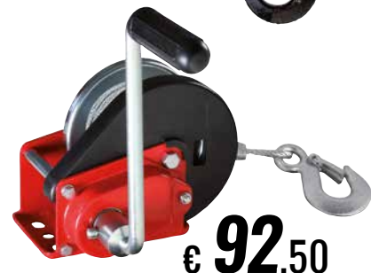
1650140 VERRICELLO MANUALE CON FRENO AUTOMATICO, FUNE E GANCIO Portata 680kg. Lunghezza fune 10m. Freno automatico di sicurezza.
