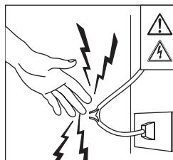
Riesgo de electrocución con peligro de muerte. No toque las partes que se encuentran bajo tensión eléctrica y mantenga una distancia de seguridad. Antes de efectuar cualquier operación de mantenimiento desconecte el enchufe de la toma de alimentación.
