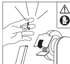
Les organes en mouvement et les bavures peuvent provoquer des blessures aux mains. Mettez des gants de protection et maintenez une distance de sécurité par rapport à la zone de meulage.
