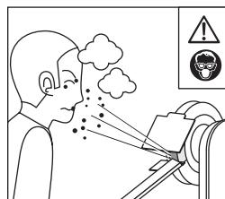
Lancio di scintille e polvere verso gli occhi ed il corpo dell'operatore. Indossate occhiali di protezione, maschera antipolvere e abbigliamento robusto.
