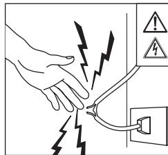
Rischio di scossa elettrica con pericolo di morte. Non tocicate le parti in tensione elettrica e mantenete una distanza di sicurezza. Prima di ogni manutenzione scolate la spina dalla presa di alimentazione.
