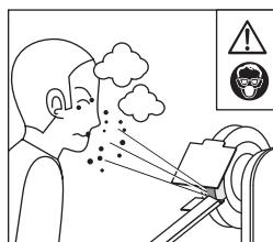
Lanzamiento de material y polvo hacia los ojos y el cuerpo del operador.
