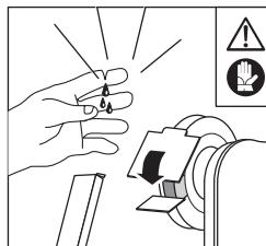
Partes en movimiento y rebabas cortantes que provocan heridas en las manos. Póngase guantes de protección y mantenga una distancia de seguridad con respecto a la zona de esmerilado.
