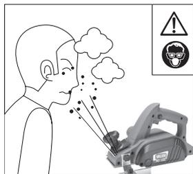
Lancio di materiale e polvere verso gli occhi ed il corpo dell'operatore. Indossate occhiali di protezione e maschera antipolvere.
