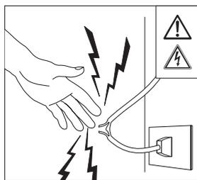
Rischio di scossa elettrica con pericolo di morte. Non toccate le parti in tensione elettrica e mantenete una distanza di sicurezza. Prima di ogni manutenzione scollegate
