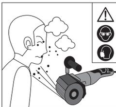
Lancio di materiale e scintille verso gli occhi ed il corpo dell'operatore. Indossate occhiali di protezione e maschera antipolvere.
